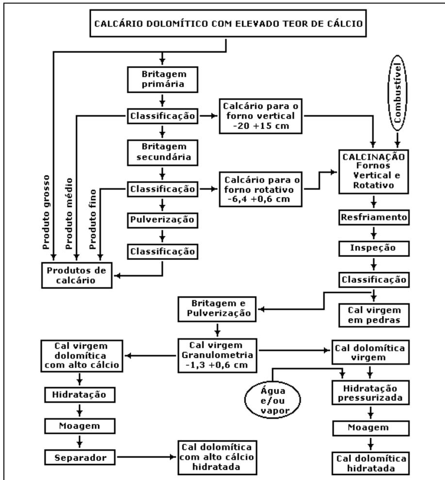
Figura 2 - Fluxograma do circuito de obtenção de cal com base em carbonato de cálcio dolomítico (Freas, 1994).
